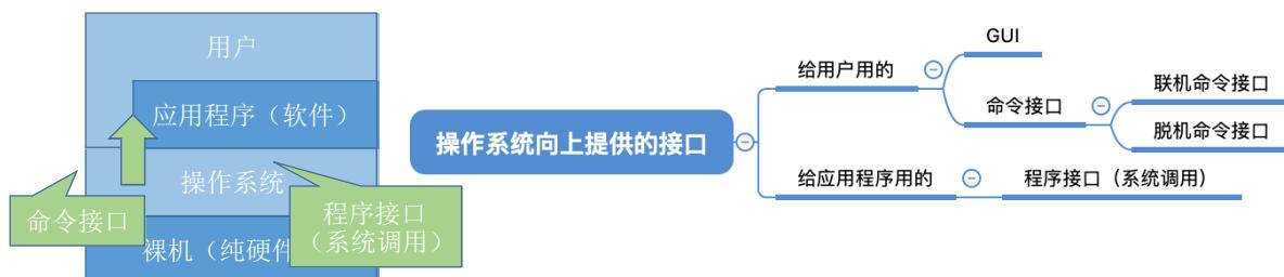
“系统调用”是操作系统提供给应用程序（程序员/编程人员）使用的接口，可以理解为一种可供应用程序调用的特殊函数，**应用程序可以通过系统调用来请求获得操作系统内核的服务**
