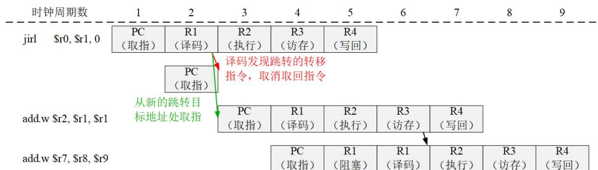
图 9.16: 优化控制相关处理后的流水线时空图
