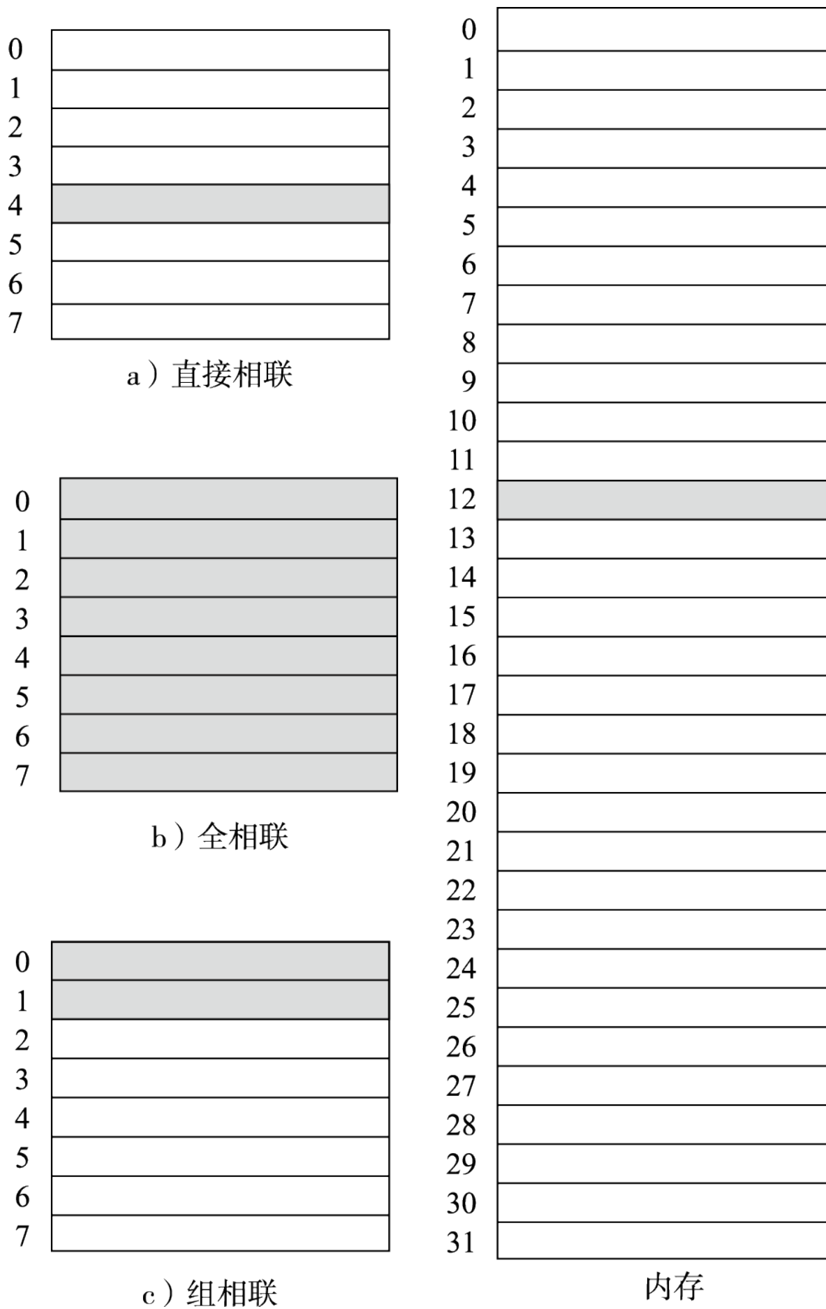
图 9.24: 直接相联、全相联、组相联映射
